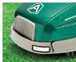
Pare-chocs Stoßsensor und Ladeanschluss
